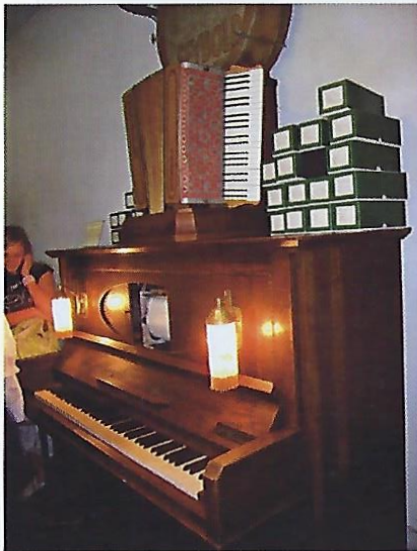
Mechanisches Klavier, das nach gelochtem Melodienstreifen (zwischen den Lampen) spielt und mit Ziehharmonika verbunden ist Foto: Heinrich Klose, Hessen, Kassel
